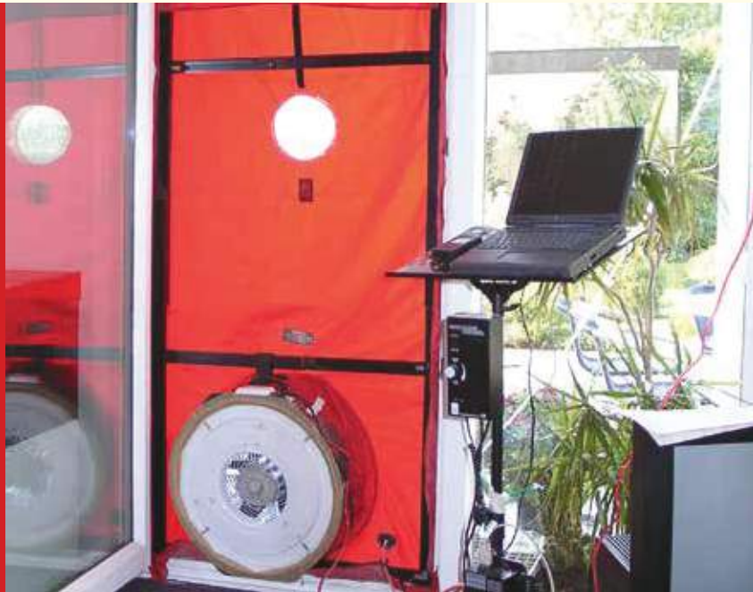
Hava basıncı testi için fan
